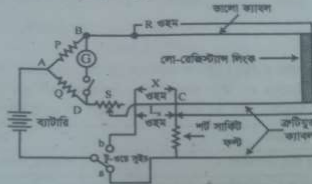
চিত্র : ৩.৫ ভার্লি লুপ টেস্ট শর্ট সার্কিট বর্তনী
