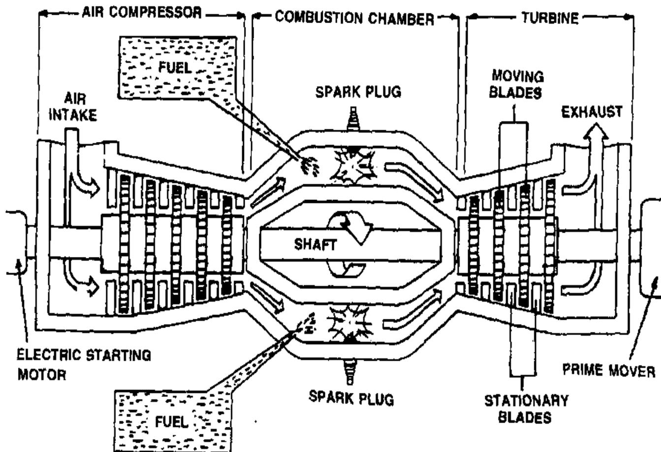
Fig. 2.28: HOW A GAS TURBINE SYSTEM WORKS
