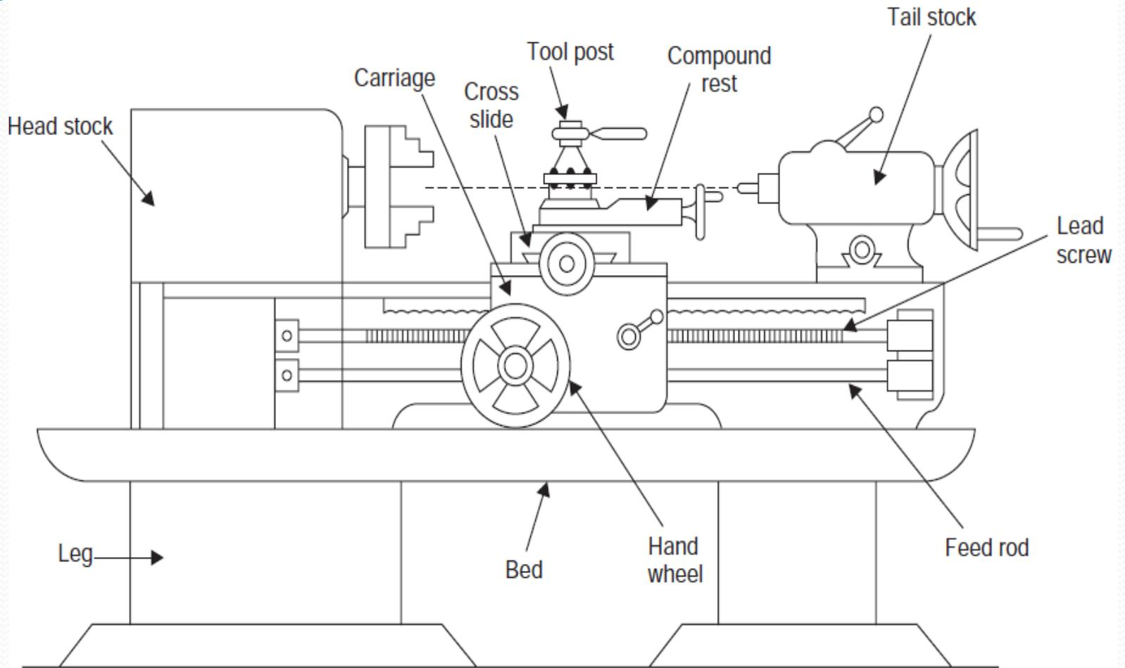
**Fig. 1. Lathe Machine.**
