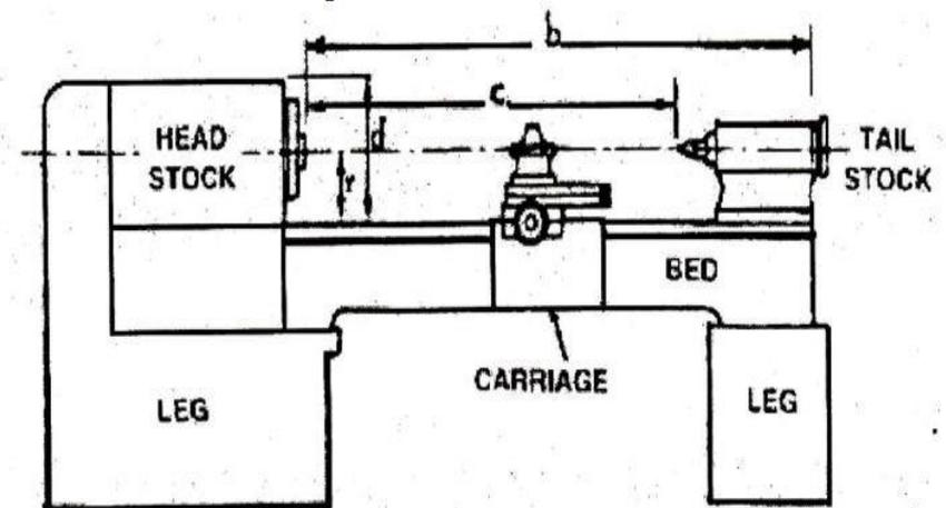
**Fig. : SPECIFICATION OF A LATHE**
