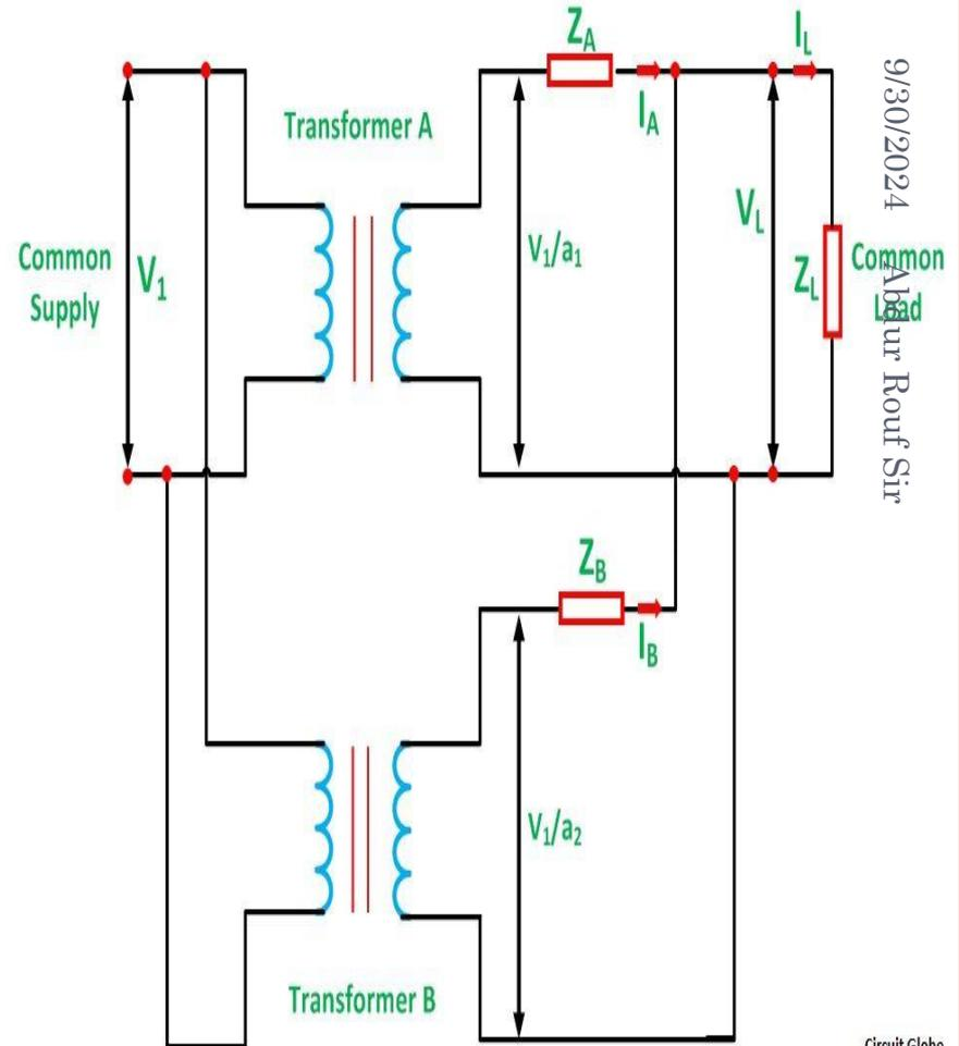
৯.৬। সমান ভোল্টেজ রেশিওতে ট্রান্সফরমারের প্যারালাল অপারেশন (Describe the parallel operation of transformer with equal voltage ratio):
