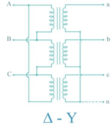
৭.৩। স্টার-স্টার (Y-Y), ডেলটা-ডেলটা ( $\Delta$ - $\Delta$ ), স্টার-ডেলটা (Y- $\Delta$ ), এবং ডেলটা-স্টার ( $\Delta$ -Y) সংযোগপদ্ধতি (The n delta-delta, star-delta, delta-star connection):
